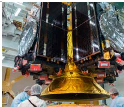
Separationssystem för att lösgöra fyra Galileo-satelliter. Foto: RUAG Space AB
