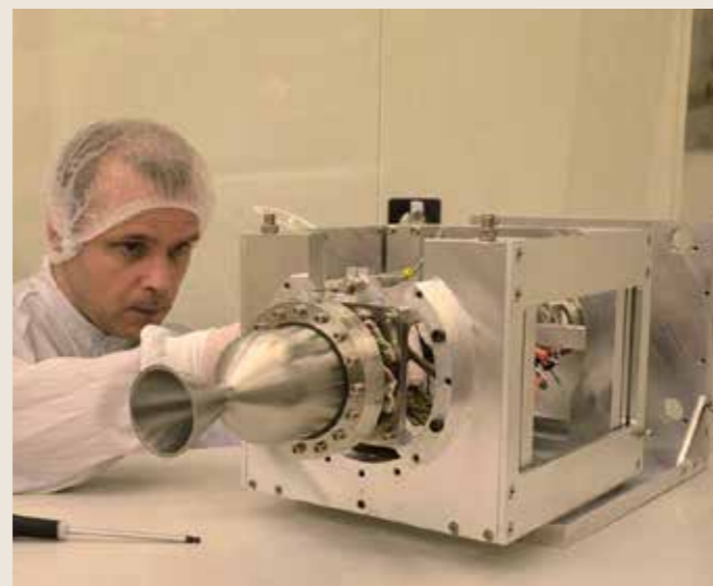
Tomas Hasanof förbereder provbränning av en 200 N HPGP motor. Foto: Ecaps
