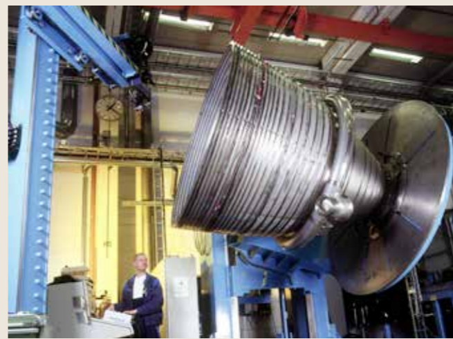
Tillverkning av brännkammare till Ariane 5. Foto: GKN Aerospace
